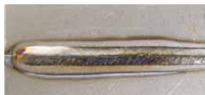
Edelstahl – Stichloch-Schweißen in 6 mm Materialstärke
