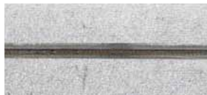
Stahl – Plasma-Schweißen in 0,5 mm Materialstärke
