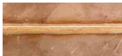
Kupfer – Plasma-Schweißen in 0,6 mm Materialstärke
