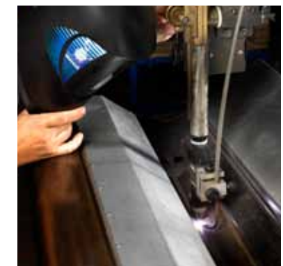
Plasmaschweißen von legiertem Stahl in Längsnahtautomat
