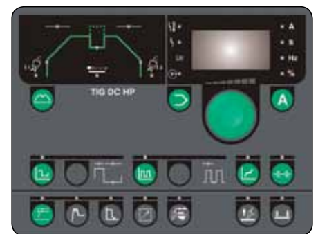
Pi DC HP mit Synergy Plus ™ WIG HP-Steuerung mit klar gegliedertem Display und serienmäßiger Synergy PLUS ™ Funktion.
