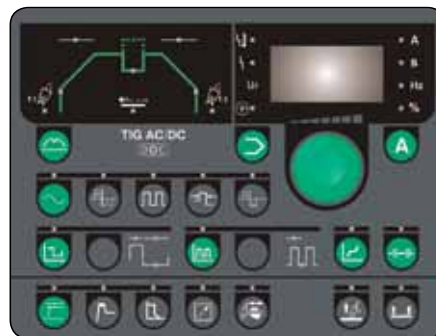
Pi AC/DC mit D.O.C. ® WIG AC/DC-Steuerung mit allen relevanten Parametereinstellungen für professionelle Schweißsätze bei allen Materialien.
