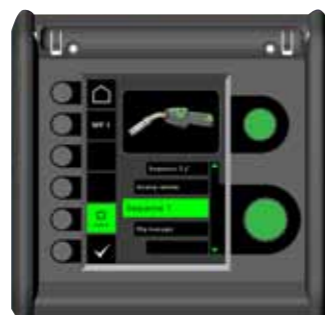
Wahl des Brenners im Hauptmenü. Die Galaxy unterstützt alle Funktionalitäten des MIG-A Twist-Schweißbrenners.
