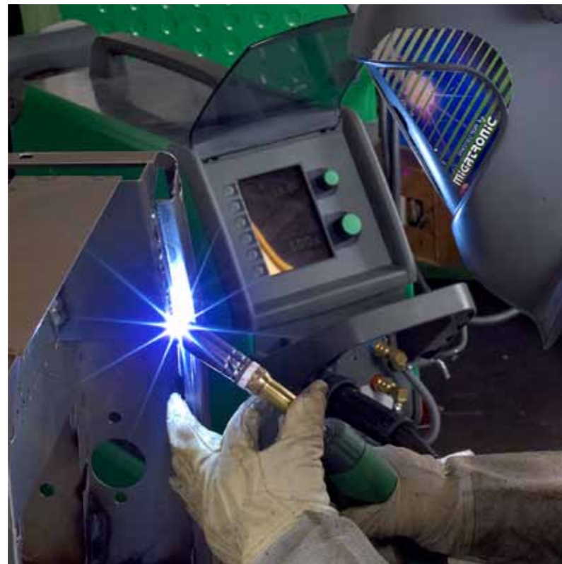
Die Sigma Galaxy ist mit einem leistungsstarken Computer ausgestattet, der den Prozess 50.000-mal pro Sekunde anpasst.
