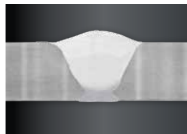
IAC geschweißte Wurzellagen vertikal nach unten in 10 mm Stahl, gefüllt mit zwei vertikal nach unten gehenden Sequenzgängen.
