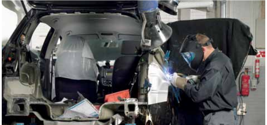
MIG/MAG-Schweißen von Dünnblechen
